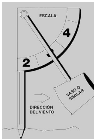
Diagrama 6 Esquema del principio de funcionamiento de un anemómetro de empuje
