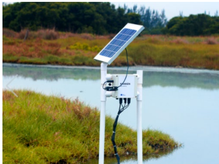
Imagen A2.2 Sensor de control de calidad del agua KRAKEN
