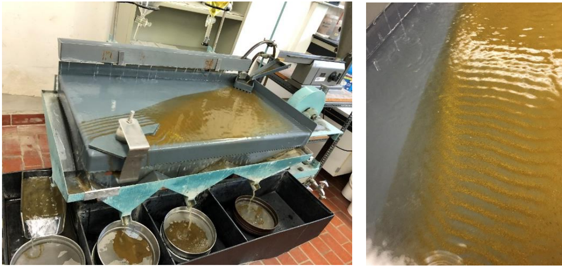
Fig. 4: Mesa vibratoria para separación gravimétrica con relaves y concentrado (Fuente: BGR, 2022)
