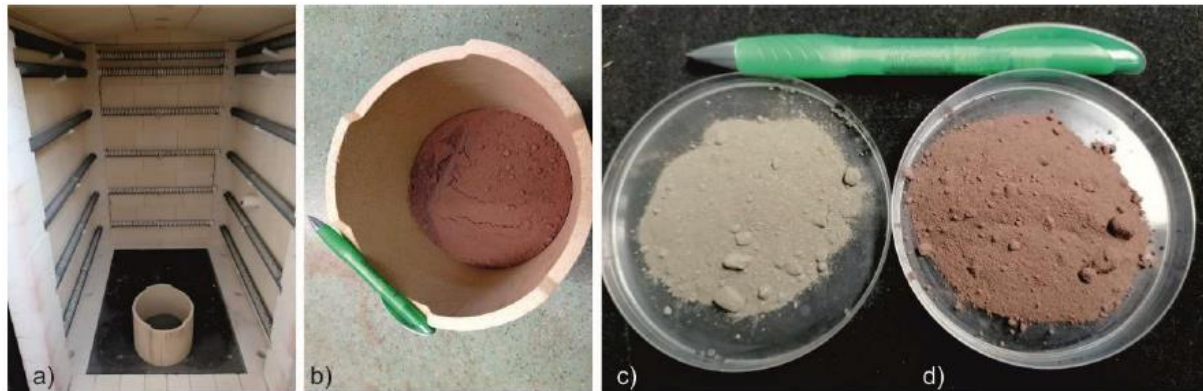
Fig. 7: Recocido de la muestra MLR_M3; a) antes del recocido; b) después del recocido a 800°C, c/d) comparación del color de la muestra inicial M3_L (c) y la muestra recocida M3_R (d) antes de la lixiviación (después de la lixiviación) (Fuente: GEOS, 2021)
