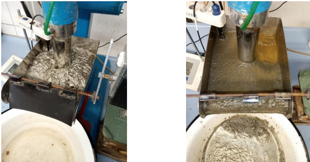
Fig. 5: Célula de flotación durante los experimentos de flotación para el enriquecimiento del oro (Fuente: BGR, 2022)
