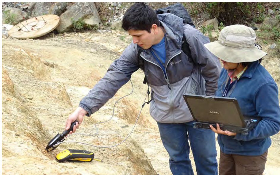
Fotografía 8.1 Toma de firmas espectrales en el flanco este del depósito de relaves La Ciénaga "I"
