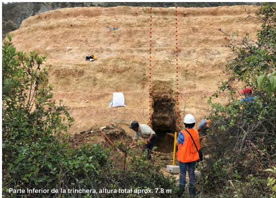
Fotografía 1.1 Vista mirando al este. Apertura de trinchera en depósito "I" (fotografía tomada por Dr. W. Morche)
