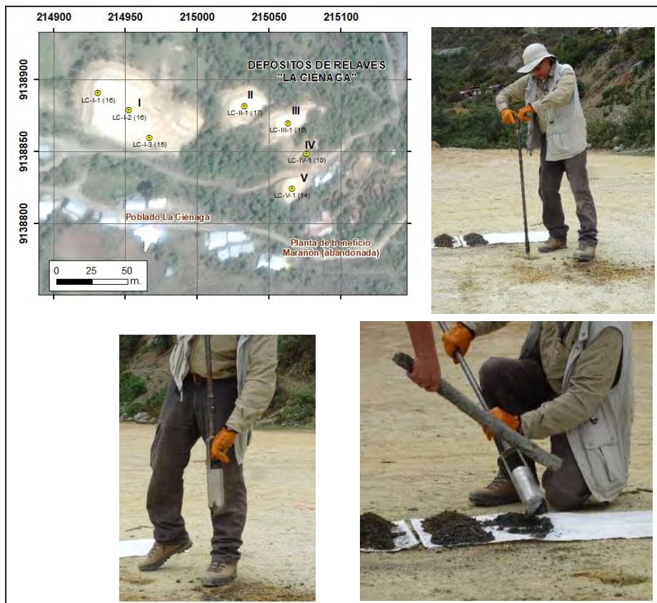
Figura 5.29 Ubicación y muestreo de relaves con sondajes "Auger"
