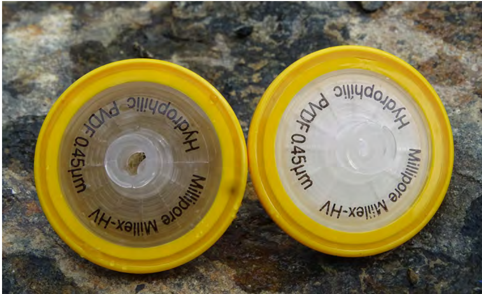
Fotografía 6.1 Filtros para agua. Derecha: sin uso. Izquierda: filtro reteniendo partículas en suspensión
